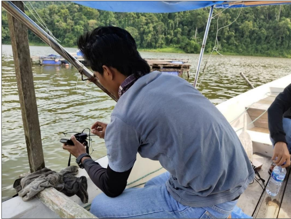
Gambar 3 Pemasangan transduser GPS Garmin Echo sounder
